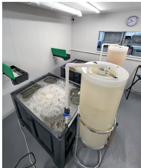
Een proefopstelling, met op de voorgrond een ronde 'settlingtank' met conische bezinker
